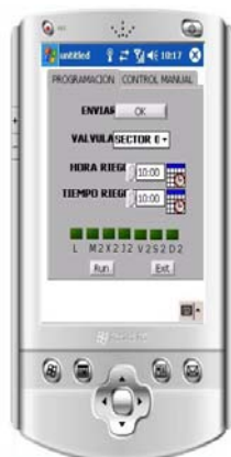
Fig. 6. Programa de control de riego con PDA mediante comunicación Bluetooth.
