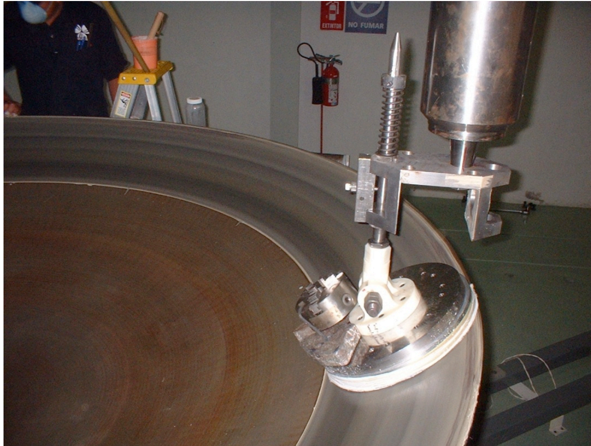
Molde de 2.5m de diámetro del secundario del Gran Telescopio Milimétrico
