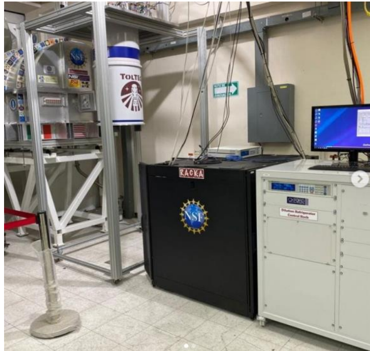
Ensamblado del criostato y el frigorífico de dilución en el laboratorio de GTM (a 4600m)
