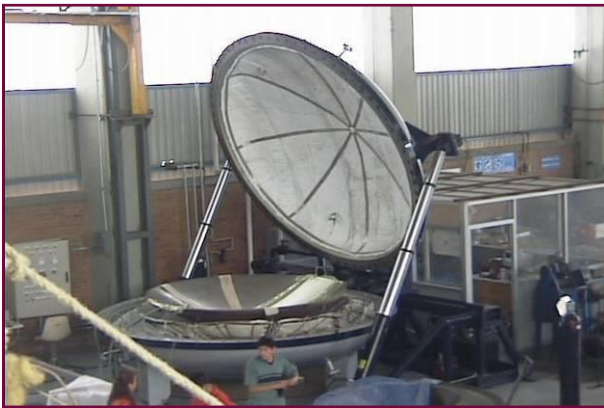
La autoclave en una nave industrial del CIATEQ, con el molde del reflector secundario en su interior. A la derecha, la membrana de soporte del espejo ya curada.
