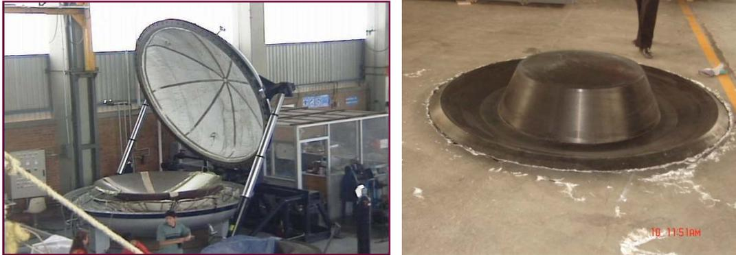
*La autoclave en una nave industrial del CIATEQ, con el molde del reflector secundario en su interior. A la derecha, la membrana de soporte del espejo ya curada.*
