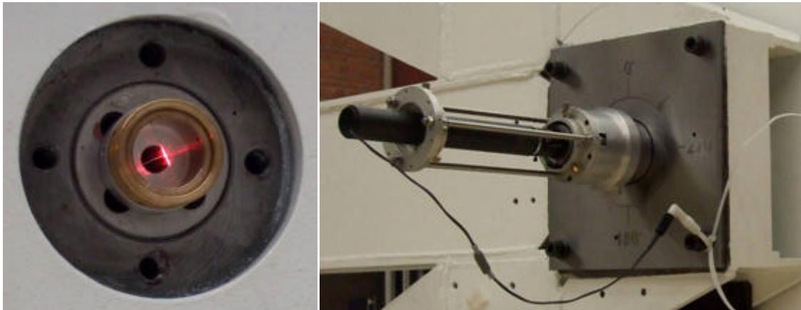
*Izquierda: target instalado en la flecha del motor, eje de dirección. Derecha: alineador axial instalado al exterior de la flecha del motor con un adaptador fabricado en CIATEQ.*
