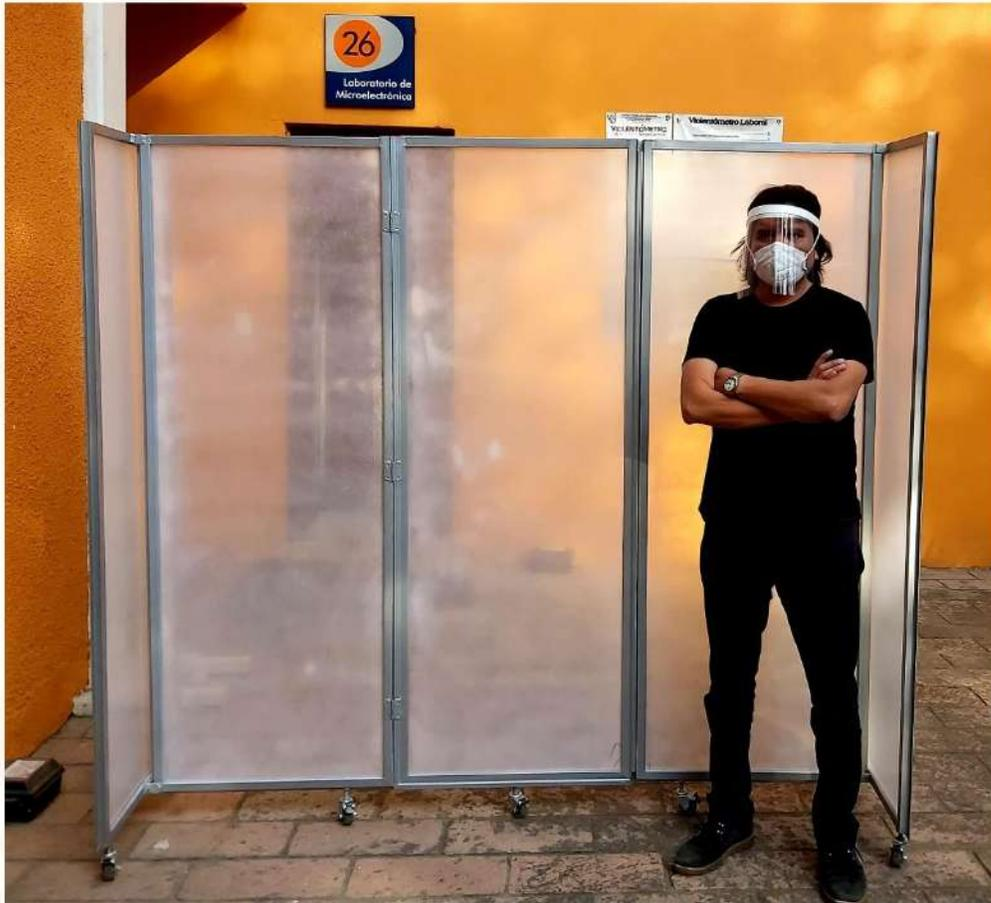
Paneles de gran área tipo biombo, el cual es plegable, herméticamente sellado en los bordes, de fácil transporte y de gran área que lleva un recubrimiento fotocatalítico para asegurar 1) contención de las nubes de microgotas de coronavirus e 2) inactivación constante del virus SARS-Cov-2 adherido sobre sus superficies.
