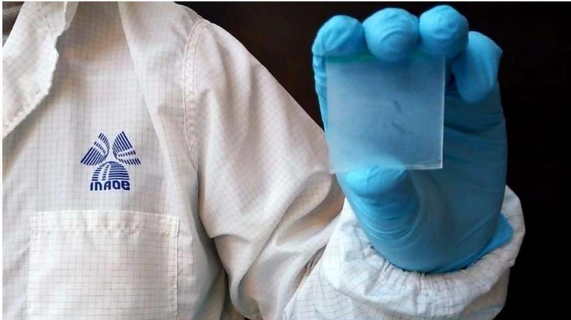
Primeros recubrimientos fotocatalíticos sobre superficies de acrílico desarrollados en INAOE. Múltiples pruebas de optimización y caracterización se realizan sobre áreas pequeñas para después escalar hacia áreas más grandes.
