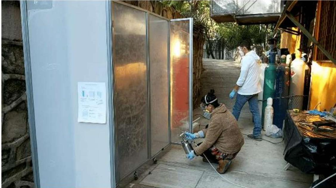
Procedimiento de depósito de película fotocatalítica de alta calidad sobre superficies de acrílico de área grande por el método de *spray-coating* que ha sido optimizado para producir películas de alta calidad y muy bajo costo.
